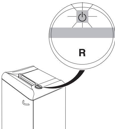
**RUS** При отсутствии бумаги аппарат автоматически останавливается.
