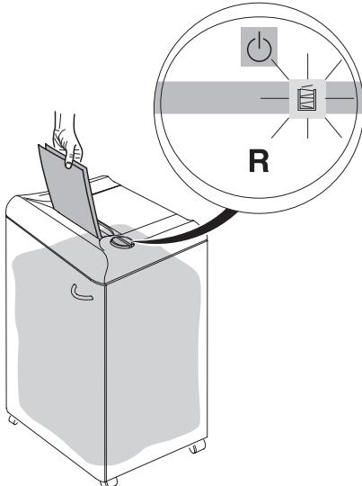
**RUS** При заполнении пластикового мешка аппарат остановится автоматически. Должен загореться индикатор «мешок заполнен». Замените пластиковый мешок. (смотри стр. 8).
