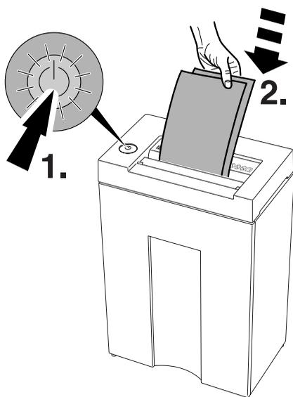
**RUS** Нажмите включатель
