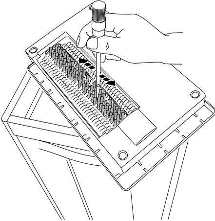
**RUS** Периодически очищайте режущий механизм аппарата.
