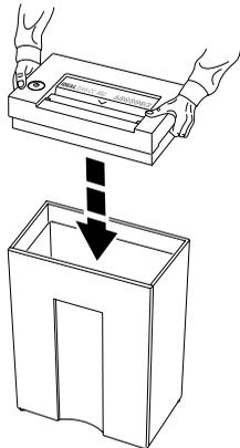
**RUS** Установите механизм на корпус аппарата.
